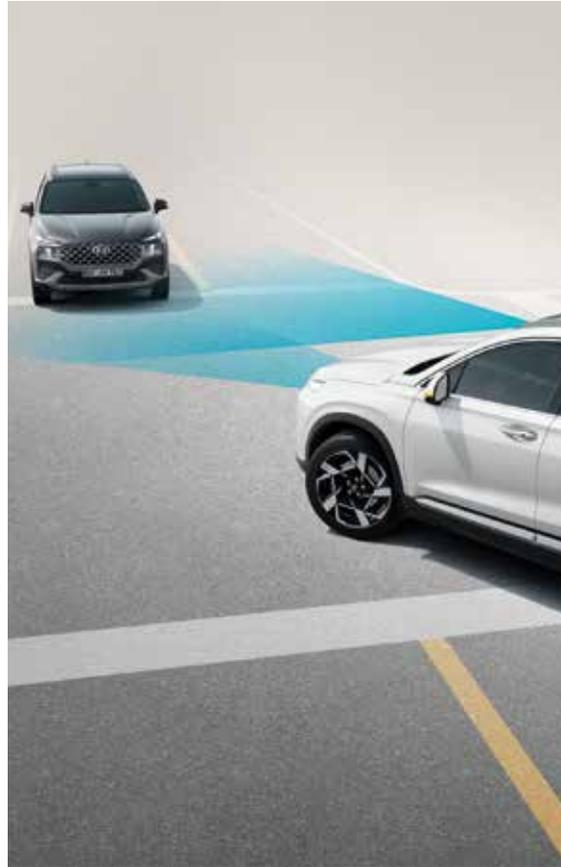
**Autonomer Notbremsassistent (FCA, Abbiegen an Kreuzungen).**
