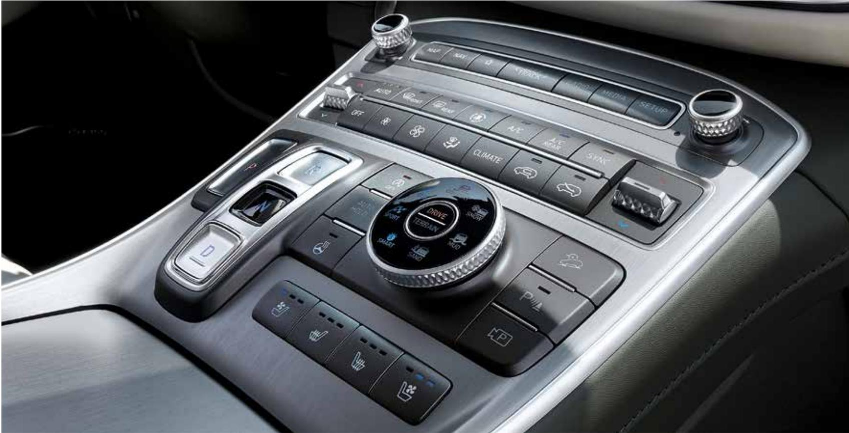
Brückenkonzole und Shift-by-Wire-Automatikgetriebe. Shift by Wire ist nur verfügbar für Hybrid und Plug-in-Hybrid (ab Frühjahr 2021).<sup>3</sup>
