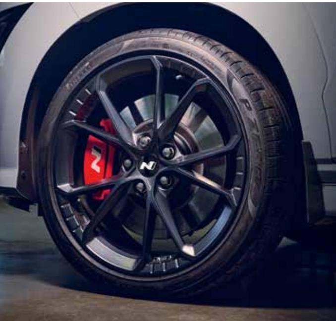
Durch Reduzierung des ungefederten Gewichts verbessern die geschmiedeten 19-Zoll-Leichtmetallfelgen Handling und Traktion. Die Initialen „HN“ auf den Hochleistungsreifen weisen darauf hin, dass sie speziell für Hyundai N entwickelt wurden.
