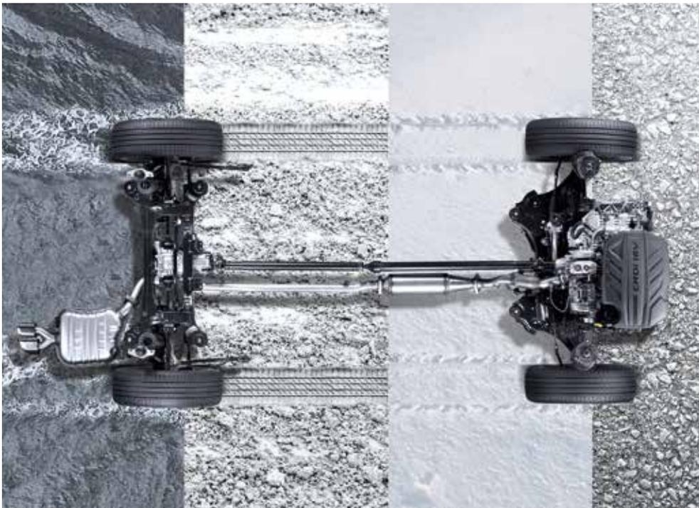
Das HTRAC Allradsystem<sup>1</sup> sorgt durch variable Bremskraftverteilung zwischen den einzelnen Rädern rechts und links sowie dynamische Antriebskraftverteilung vorn und hinten für Stabilität bei Kurvenfahrten und auf anspruchsvollen Untergründen.
