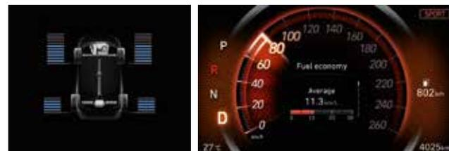
Farbe des optionalen Instrumentenclusters, passt sich dem gewählten Fahrmodus an (COMFORT, ECO, SPORT oder SMART). Der Modus ECO sorgt für erhöhte Effizienz, während der SPORT-Modus die Antriebskraft optimal für einen dynamischen Fahrstil auf die Vorder- und Hinterachse verteilt. Der SMART-Modus passt den optimalen Modus der jeweiligen Fahrsituation automatisch an.
