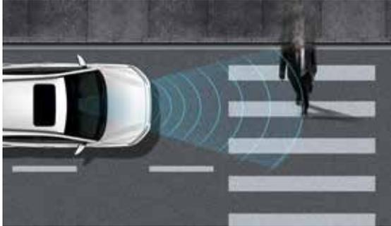
**Autonomer Notbremsassistent inklusive Frontkollisionwarner und Fußgängererkennung (FCA).<sup>1</sup>** Das FCA-System überwacht mit Kamera und Radarsensor den vorausfahrenden Verkehr. Stellt der Notbremsassistent fest, dass eine Gefährdung durch andere Fahrzeuge (bis 180 km/h) oder für Fußgänger (bis 64 km/h) besteht, löst er zunächst eine optische und akustische Warnung aus und leitet im Notfall eine Teil- oder Vollbremsung ein, sofern Sie die Bremse nicht bereits selbst betätigt haben.
