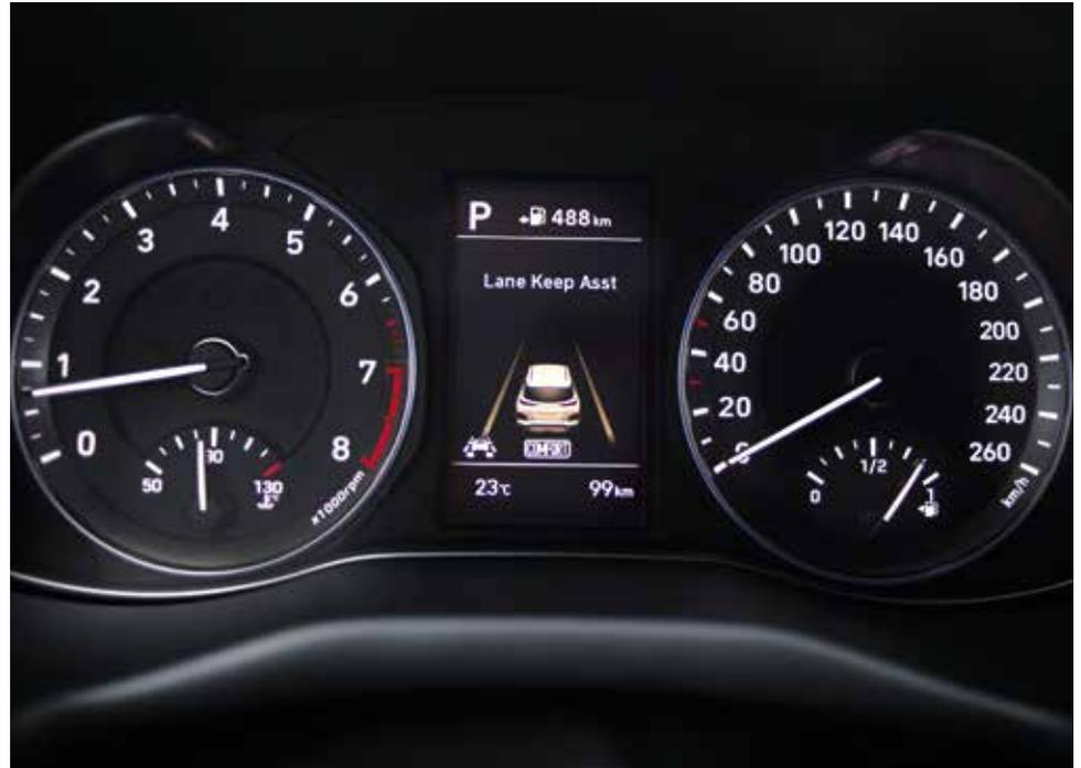
**Bordcomputer** – optimal platziert und leicht lesbar zeigt dir ein 4,2-Zoll-LCD-Bildschirm<sup>1</sup> wichtige Fahrinformationen an: den Status aktiver Sicherheitsfunktionen, verbleibende Reichweite und Kraftstoffverbrauch, Navigationsanweisungen, Außentemperatur und vieles mehr.
