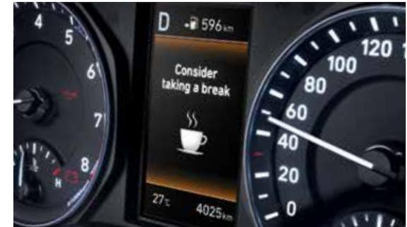
**Aufmerksamkeitsassistent.** Diese Serienfunktion hebt Sicherheit und Komfort durch kontinuierliche Überwachung und Analyse des Fahrerhaltens auf ein völlig neues Niveau. Wenn ein Muster von Müdigkeit oder Ablenkung identifiziert wird, warnt der Aufmerksamkeitsassistent mit einem akustischen Alarm sowie mit einer Popup-Nachricht und schlägt dem Fahrer eine Pause vor.
