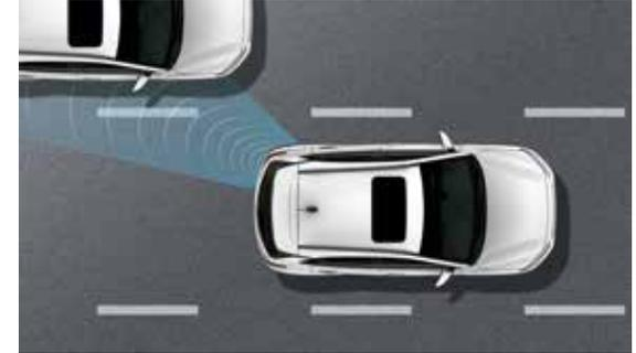
**Totwinkelassistent (BSCW) und Spurwechselassistent (LCA).<sup>1</sup>** Mithilfe von zwei Radarsensoren in der unteren hinteren Stoßstange erkennt das System Objekte im toten Winkel und warnt Sie mit einem optischen Signal. Sollten Sie in einem solchen Fall den Blinker einschalten, gibt der Spurwechselassistent ein akustisches Warnsignal.
