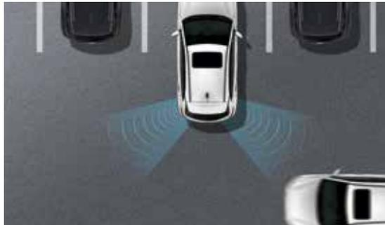
**Querkehrswarner, hinten.<sup>1</sup>** Beim Zurücksetzen aus einem engen Parkplatz verringert der Querkehrswarner das Risiko einer Kollision. Durch zwei Radarsensoren am Heck wird man im Falle von sich näherndem Querverkehr gewarnt.
