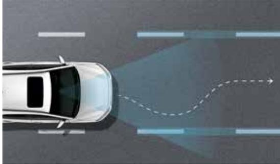
**Spurhalteassistent (LKA).** Der Spurhalteassistent überwacht mittels der vorderen Kamera die Fahrbahnmarkierungen. Sollte der Fahrer unbeabsichtigt die Spur wechseln, wird er gewarnt, und das Fahrzeug steuert gegen und lenkt zurück in die Spur, sofern Sie nicht selbst aktiv in eine andere Richtung lenken.
