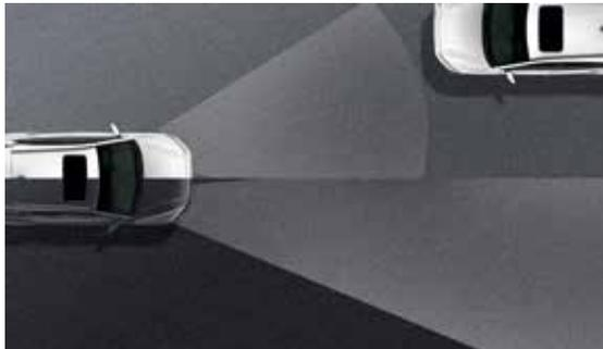
**Voll-LED-Lichttechnik.<sup>1</sup>** Der Fernlichtassistent entdeckt entgegenkommende Fahrzeuge sowie Fahrzeuge in derselben Fahrspur bei Nacht und schaltet automatisch von Fernlicht auf Abblendlicht. Das statische Kurvenlicht beleuchtet den seitlichen Bereich, wenn man in eine Kurve einbiegt, und verbessert so die Sicht bei Nacht.
