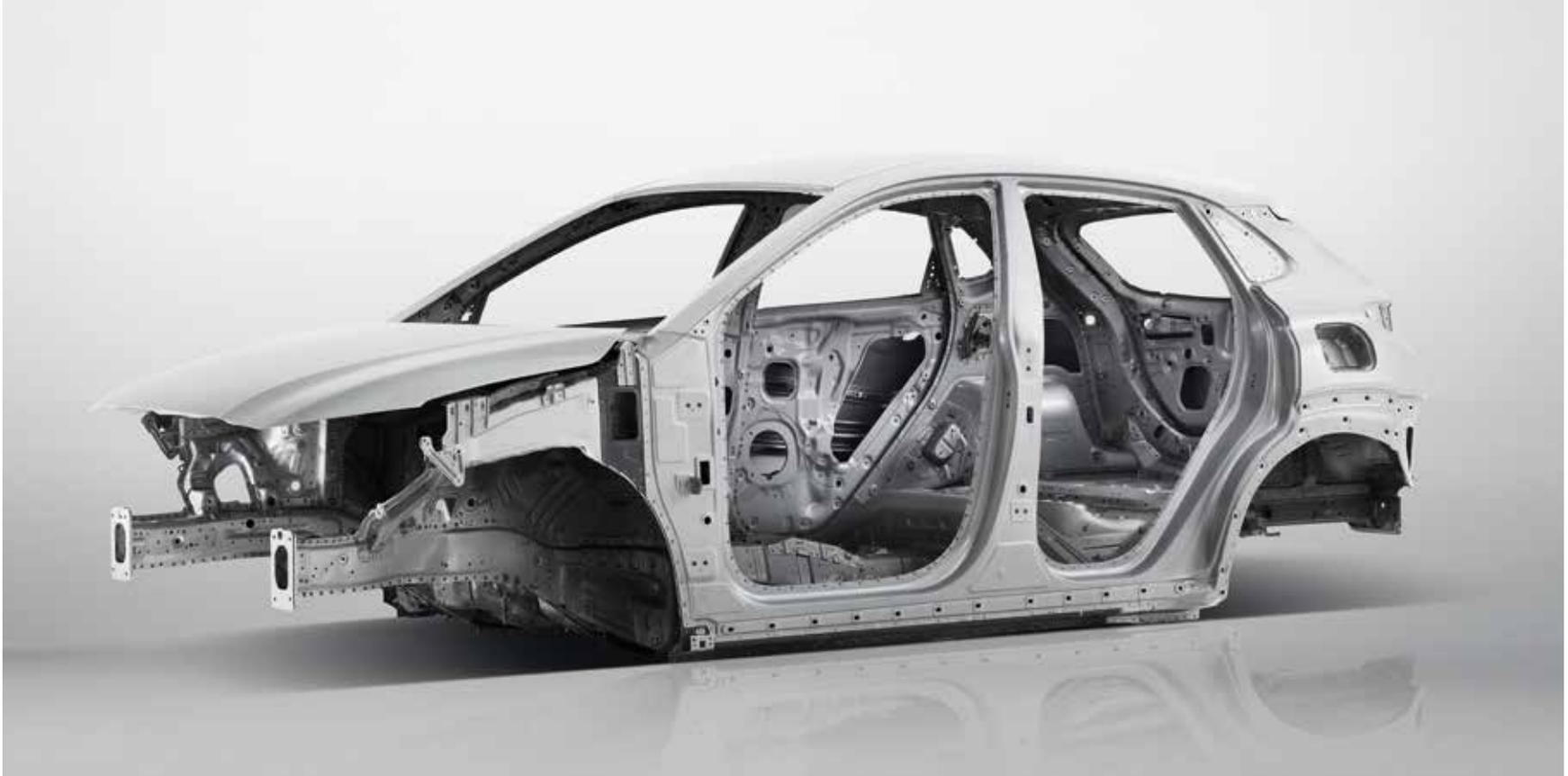
Der neue Hyundai KONA profitiert von überlegener Festigkeit durch die Verwendung von fortschrittlichem, hochfestem Stahl und einer hochwirksamen Energie-Absorption, die Passagiere im Falle einer Kollision schützt. Die Struktur der Fahrzeugkabine ist so ausgelegt, dass sie die Aufprallenergie im Falle einer Kollision verteilt, damit die Auswirkungen auf die Passagiere vermindert werden.
